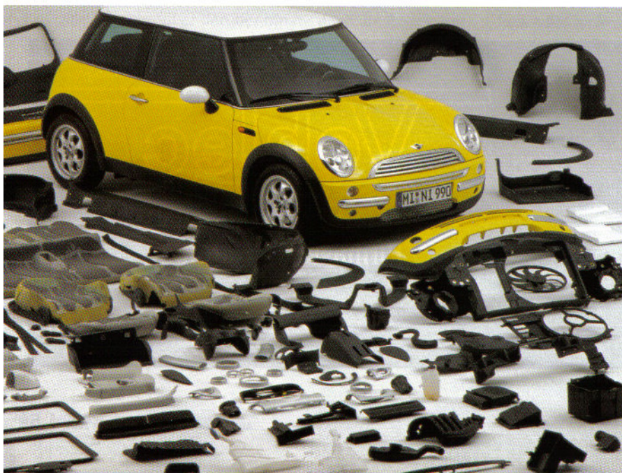
Demontierte Fahrzeugteile: Welche Elemente lassen sich mit welchem Aufwand ausbauen und wiederverwerten? Mit Software-Tools können Entwickler dies schon in der Konzeptphase erkennen. Bild: BMW Group
